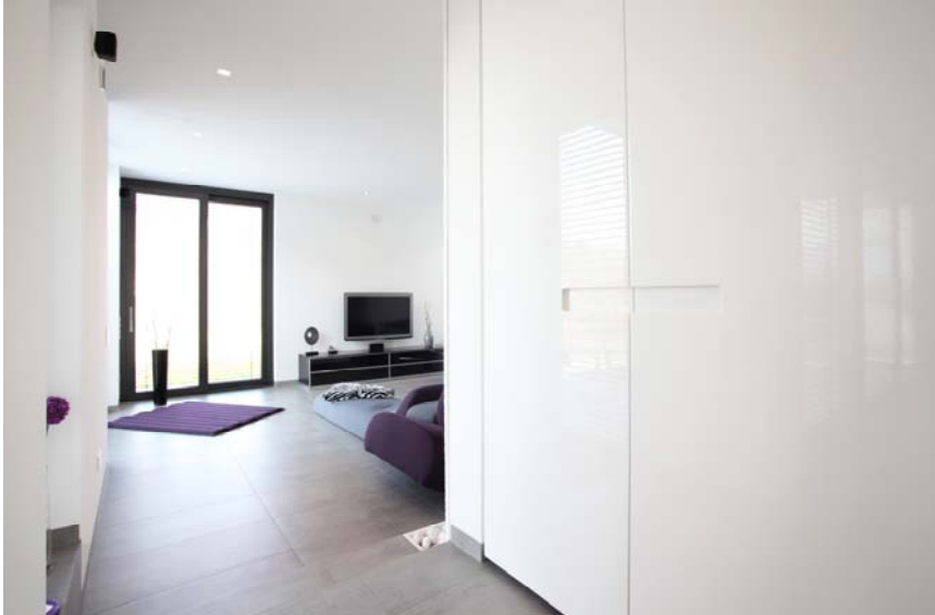
Wasserbasierte Buntlackaufbauten werden mit dem weiß pigmentierten Füller Variofill VF vorbehandelt , mit Variocryl Color lackiert und mit DC-HG in Hochglanz ablackiert. Foto: Akzo Nobel Wood Coatings GmbH – Geschäftsbereich Zweihorn
